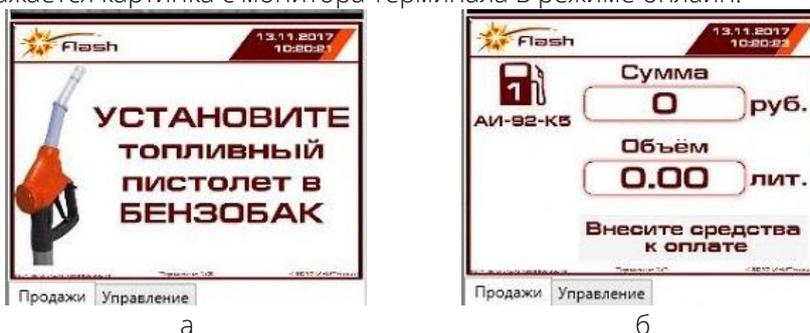
Рисунок 9 - Секция терминала самообслуживания, экран терминала в состоянии ожидания (а) и в процессе обслуживания клиента (б)
