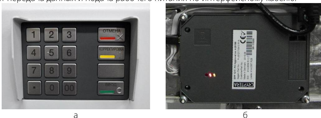
Рис.18 PIN-клавиатура (а — рабочая зона клиента, б — вид изнутри Терминала)
