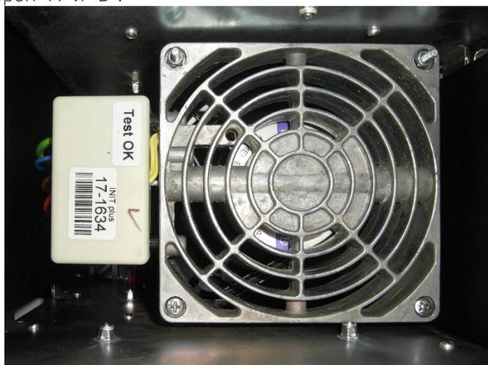
Рис.11 Система терморегуляции (нагрев)
