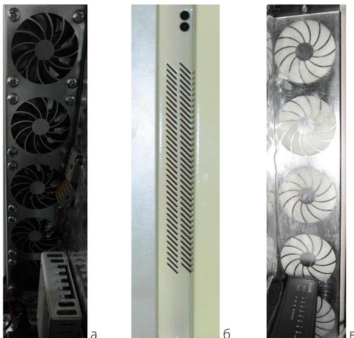
Рис.12 Блок вентиляторов (а) и отверстия воздуховода (б) стороны «А» и воздушный фильтр воздуховода стороны «В» (в)
