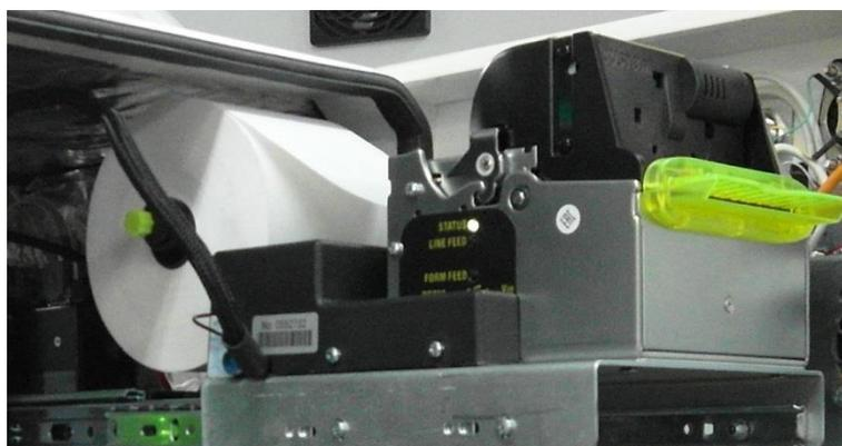
Рис.25 ККМ на направляющих DIN-рельсах выдвинута для обслуживания
