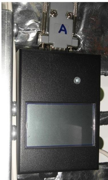
Рис.31 SIP - телефонный модуль
