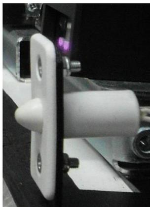
Рис.32 Концевые выключатели Терминала
